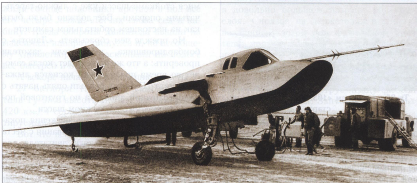
Испытания пилотируемого дозвукового самолета-аналога «105.11» (первоначально на колесном шасси)
