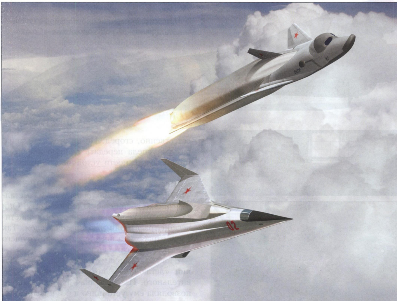
Так орбитальный перехватчик должен был отделяться от самолета-разгонщика. Разгонный блок обеспечивал ему выход на орбиту Земли
