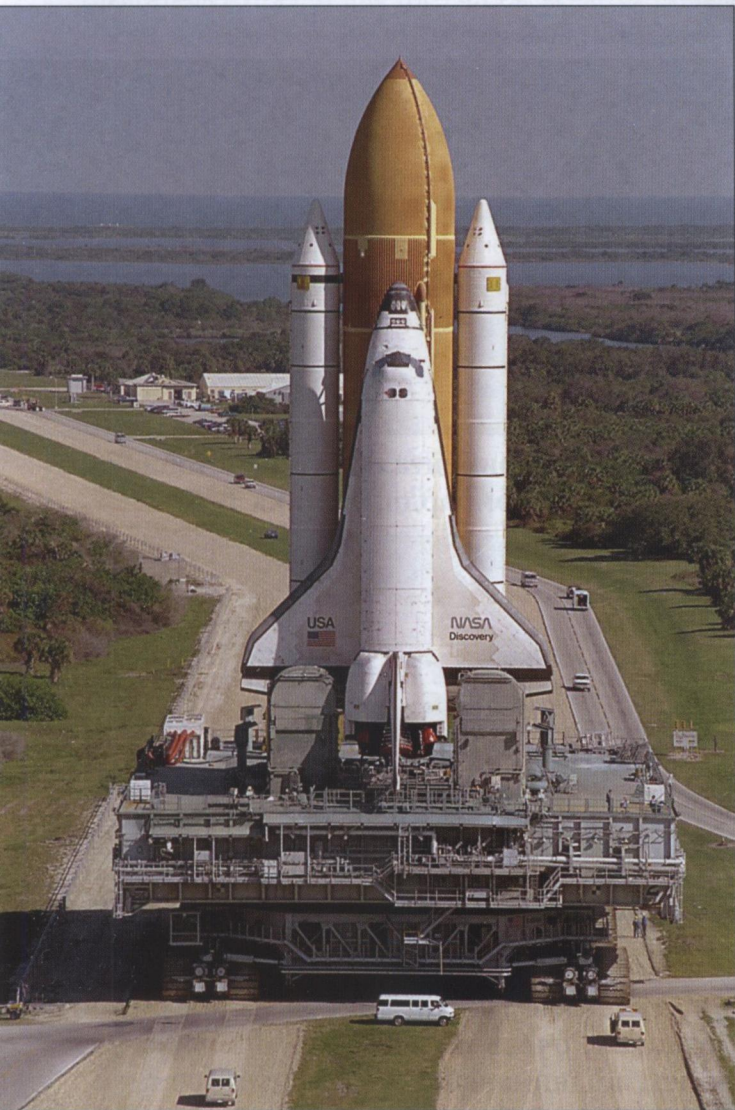
Перевозка «Шаттла» к месту старта на огромном гусеничном транспортере
