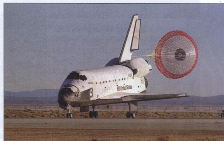
«Шаттл» производит посадку после космического полета. На последних кораблях появился тормозной парашют как у «Бурана»
