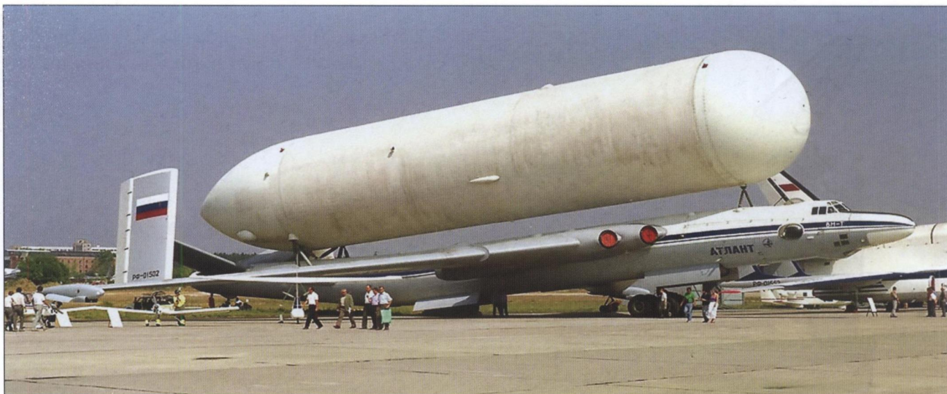
Самолет ВМ-Т с контейнером для перевозки элементов ракеты-носителя «Энергия»
